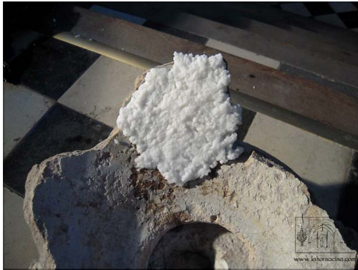
Desalación con pulpa de celulosa
