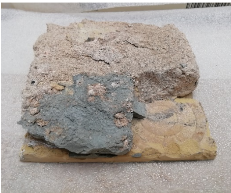
Eliminación del mortero de agarre. Anverso y reverso de azulejos de nueva factura repuestos en una intervención anterior. (diciembre 2003).
