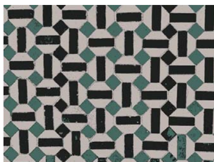
Figura 2: Imagen del ejemplo segmentada. El número de colores ha sido reducido a 3. Los brillos de la parte inferior derecha provocan errores en algunos objetos
