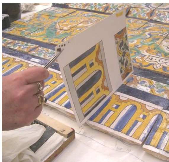
Figura 11. Dentro de la experimentación de nuevos métodos de reintegración, hubo lugar para la innovación mediante nuevos productos cerámicos: se realizaron pruebas con piezas de porcelanas sometidas a 1250° C, de 0,5 mm de grosor, diseñadas para resistir las condiciones atmosféricas más adversas.
