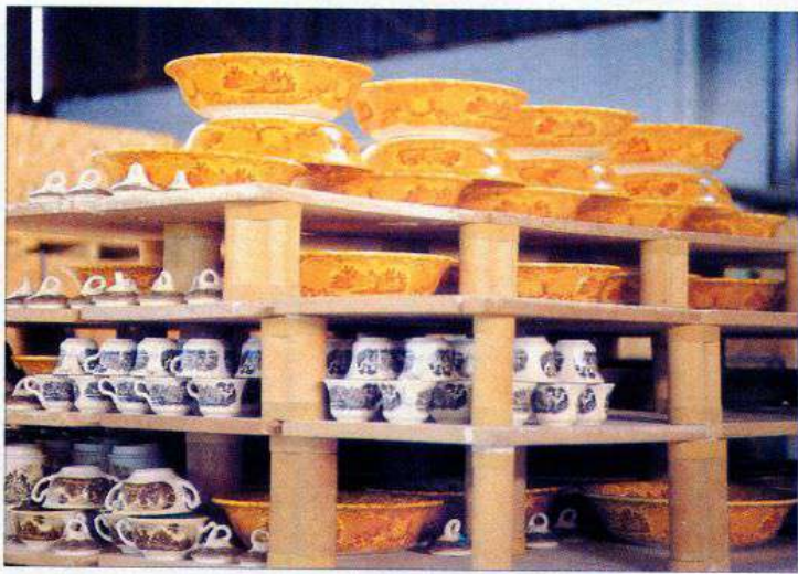
Pila de loza preparada para el horno, que le proporcionará su verdadero color.
