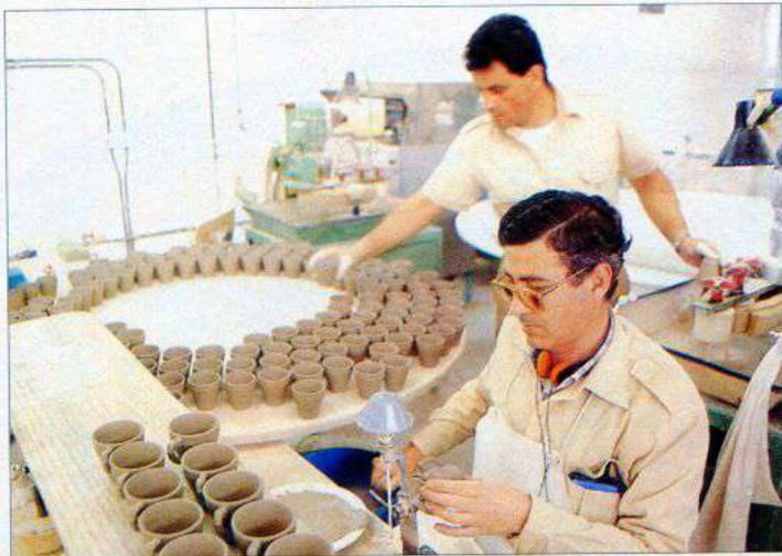
En el proceso de fabricación, todas las asas son pegadas a mano.
