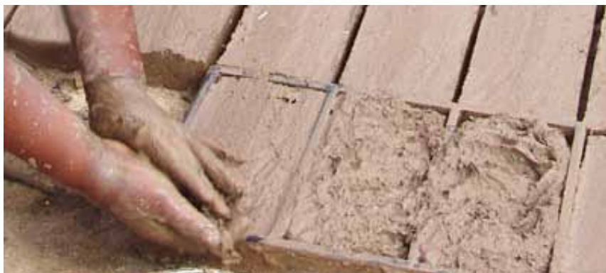
Fig. 18. Sistema artesanal de fabricación de ladrillo Foto 5425—retablocerámico.net
