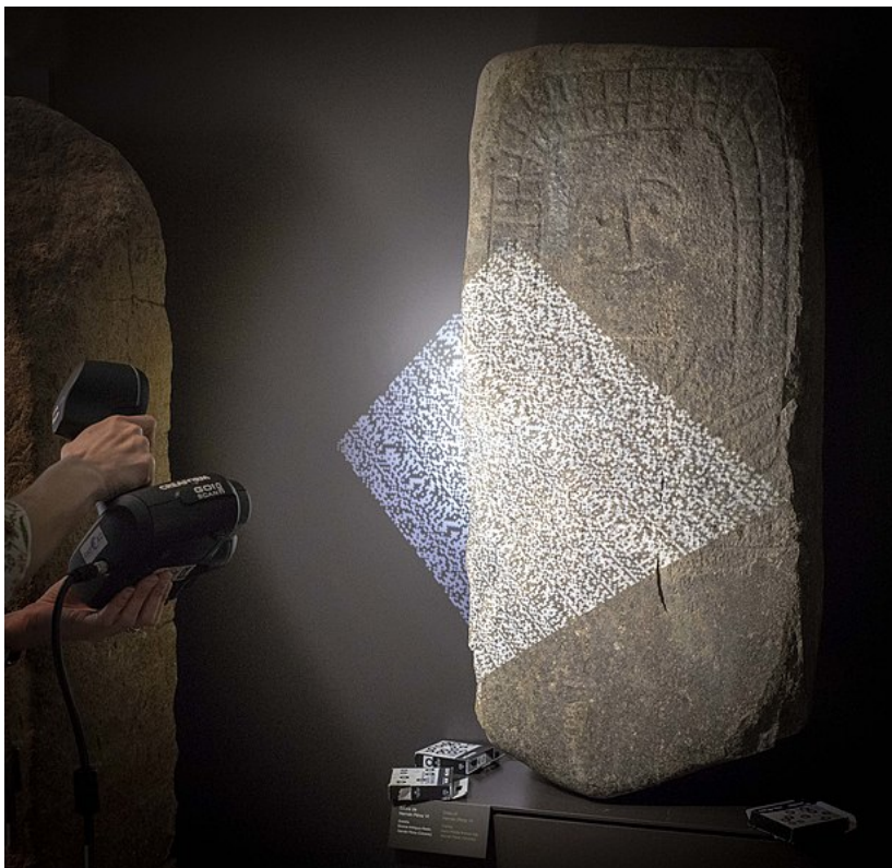
Fig.21 Construyendo un modelo 3D una estela con un escáner
