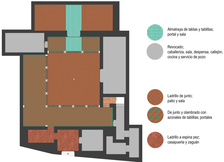
Fig. 9. Detalle de los suelos de la planta baja en la casa en la zona de las Cruces (actual Ximénez de Encisos) [Fuente: La autora].
